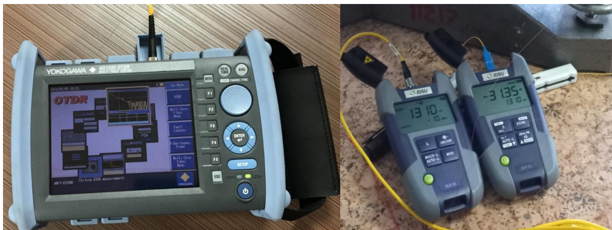
Рисунок 57 – Оптический рефлектометр Yokogawa AQ1200E типа OTDR
