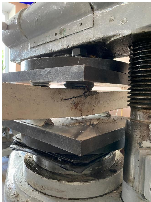
Рисунок 4 В – Фото разрушенной балки
