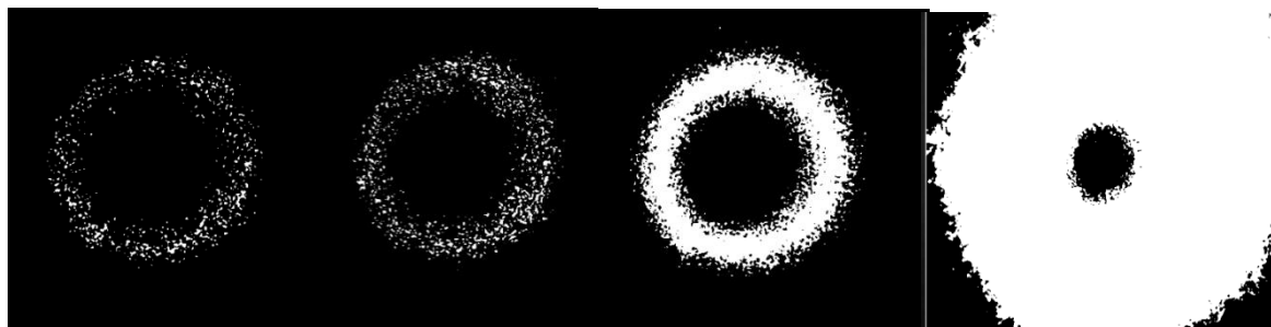
Рисунок 108 – Изменение численной картины белых пикселей и их рост по мере увеличения нагрузки на ВОД
