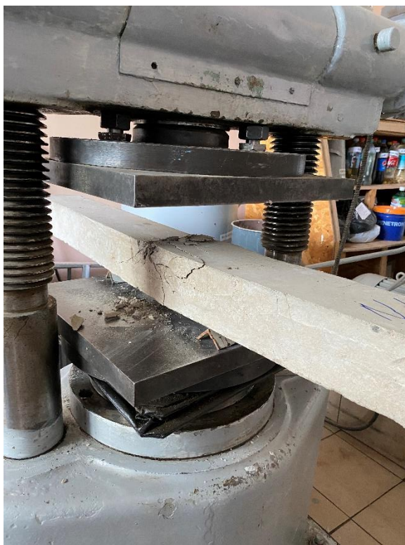
Рисунок 3 В – Фото разрушенной балки
