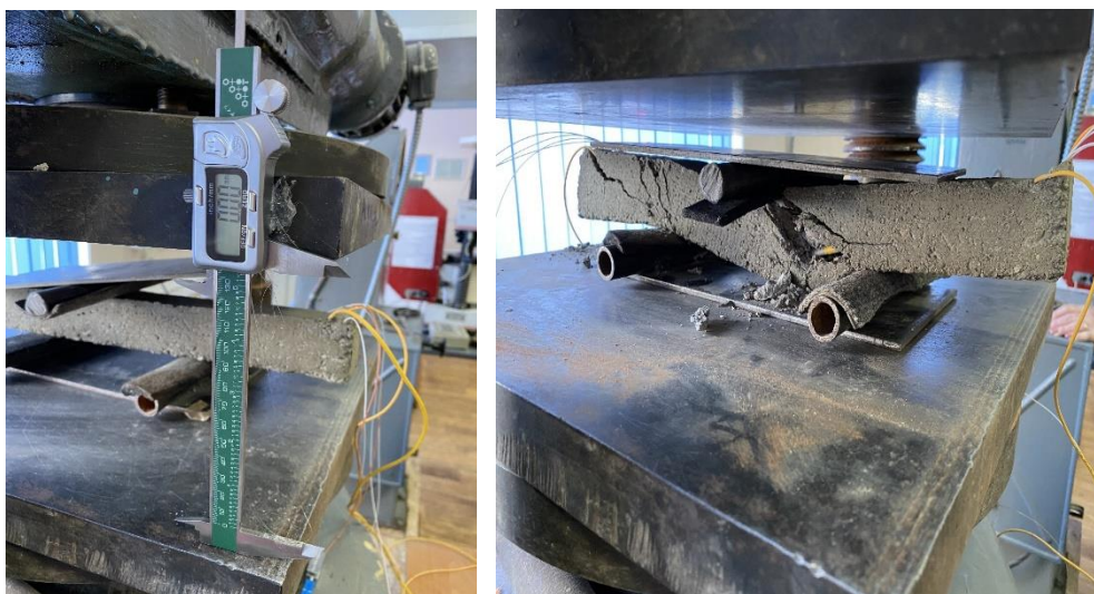
Рисунок 54 – Процесс разрушения балки
