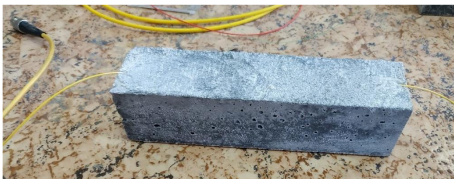
Рисунок 68 – Образец железобетонной балки размером 40x40 мм и длиной 200 мм
