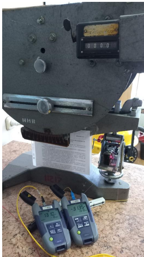
Рисунок 10 В – Приборы для измерения дополнительных потерь и калибровки АПК при испытаниях балок на машине МИИ – 100
