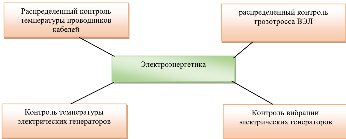
Рисунок 29 – Применение ВОД на объектах электроэнергетики
